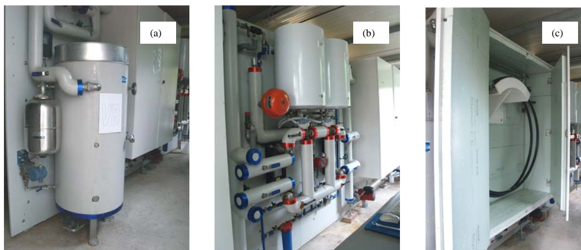
Fig. 2 - (a) autoclave per provini; (b) gruppo riscaldante; (c) armadio coibentato
